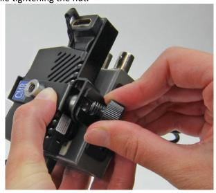
**Step 11.** Install the rod antennas.
